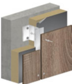
**2** Sichtbare Befestigung mit Nieten auf Alu-Unterkonstruktion | Visible attachment with rivets on aluminum substructure | Fixation visible avec rivets sur construction sous-jacente en aluminium | Fissaggio visibile con rivetti su sottostruttura in alluminio
