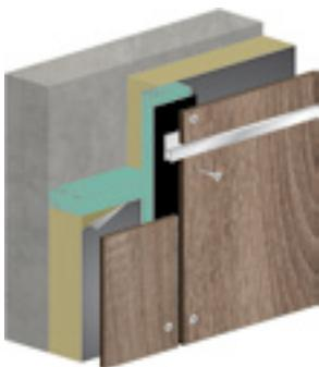
**1** Sichtbare Befestigung mit Schrauben auf Holzunterkonstruktion | Visible attachment with screws on wooden substructure | Fixation visible avec vis sur construction sous-jacente en bois | Fissaggio visibile con viti su sottostruttura in legno
