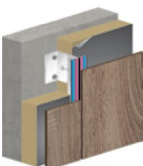
**3** Verdeckte Befestigung mit Klebstoffen | Hidden attachment with adhesives | Fixation cachée avec adhésifs | Fissaggio nascosto con adesivi
