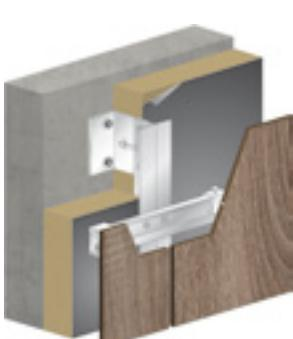
**4** Verdeckte Befestigung mit Agraffe und Anker | Hidden attachment with agraffe and anchor | Fixation cachée avec agrafes et ancrages | Fissaggio nascosto con staffa e ancoraggio
