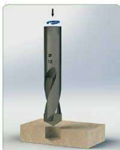
Przygotowanie otworu w materiale odbierającym.
